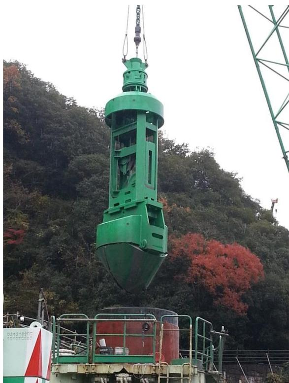
1. ワイヤ : 32 mmのワイヤを採用、最新の基礎系大型クレーンのラインプルに対応
